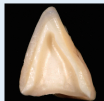
オールセラミックスクラウン切断面。チッピングはほぼなく、鋭利な断面である
